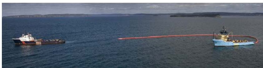
Figure 12. Barrage NorLense 1200-R - Avec deux navires déployés
