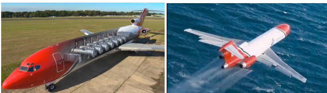
Figure 10. Système de pulvérisation aérienne de dispersant TERSUS d'OSRL
